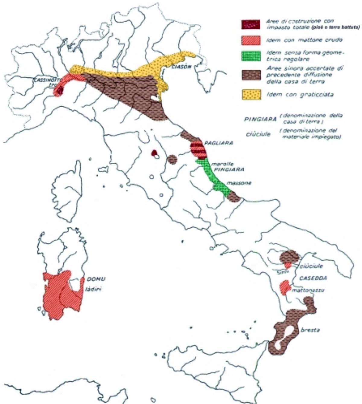
*Zone di diffusione della costruzione in terra cruda in Italia con l'indicazione delle tecniche costruttive (da Baldacci, 1958).*
