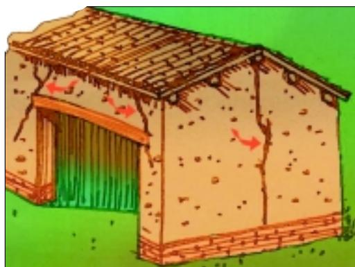
*Esempio di portico con murature soggette a punzonamento in prossimità delle aperture.*
