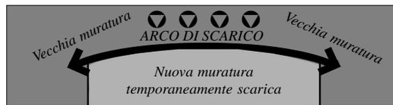
*Se la muratura viene privata di una sua porzione limitata, la parte superiore del muro non crolla ma tende a scaricare il proprio peso sulle ali laterali dell'apertura tramite un'immaginario arco di scarico. La nuova muratura al di sotto di questa fenditura non sarà più soggetta alla totalità dei pesi che gli giungevano in precedenza dall'alto.*
